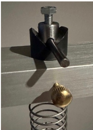
Figura 2. Dispositivo di sospensione roto-traslazionale.
